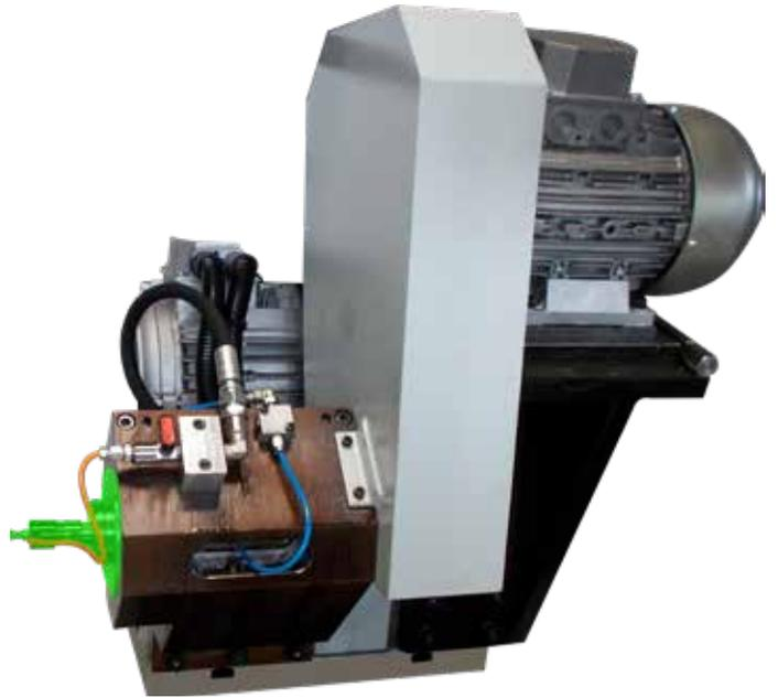
SCHLEIFSPINDEL ZUM INNENSCHLEIFEN, AN DER KIPPbaren FRONTALEN HALTERUNG POSITIONIERT
